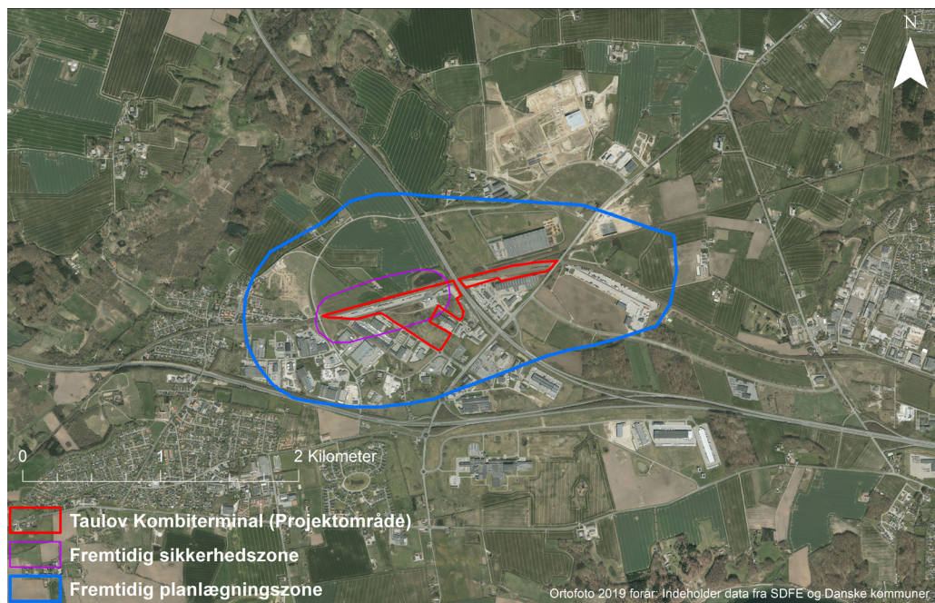
Figur 7: Taulov Kombiterminal (rød) samt den fremtidige sikkerhedszone (lilla) og planlægningszone (blå). Projektområdet består af terminal 1 og 2 samt sporgruppe 40 og arealerne uden om disse.
